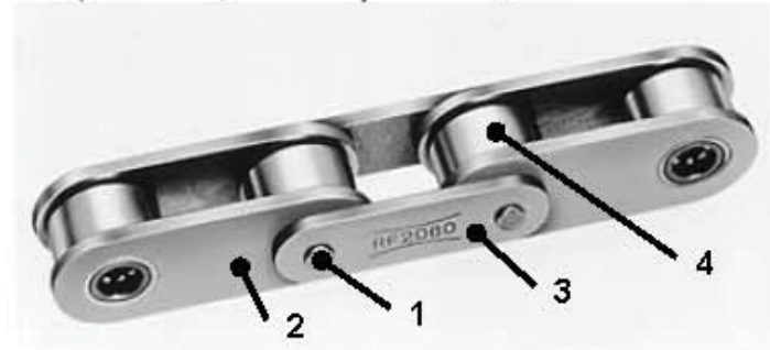
Şekil 6. Burçlu Zincir 1-Pemo 2-İç Bakla 3- Dış Bakla 4-Burç
